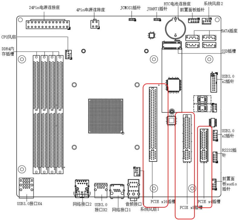
图示为主板支持标准的PCIEX16（显卡）、PCIEX8（支持X2信号）、PCIEX4接口。
